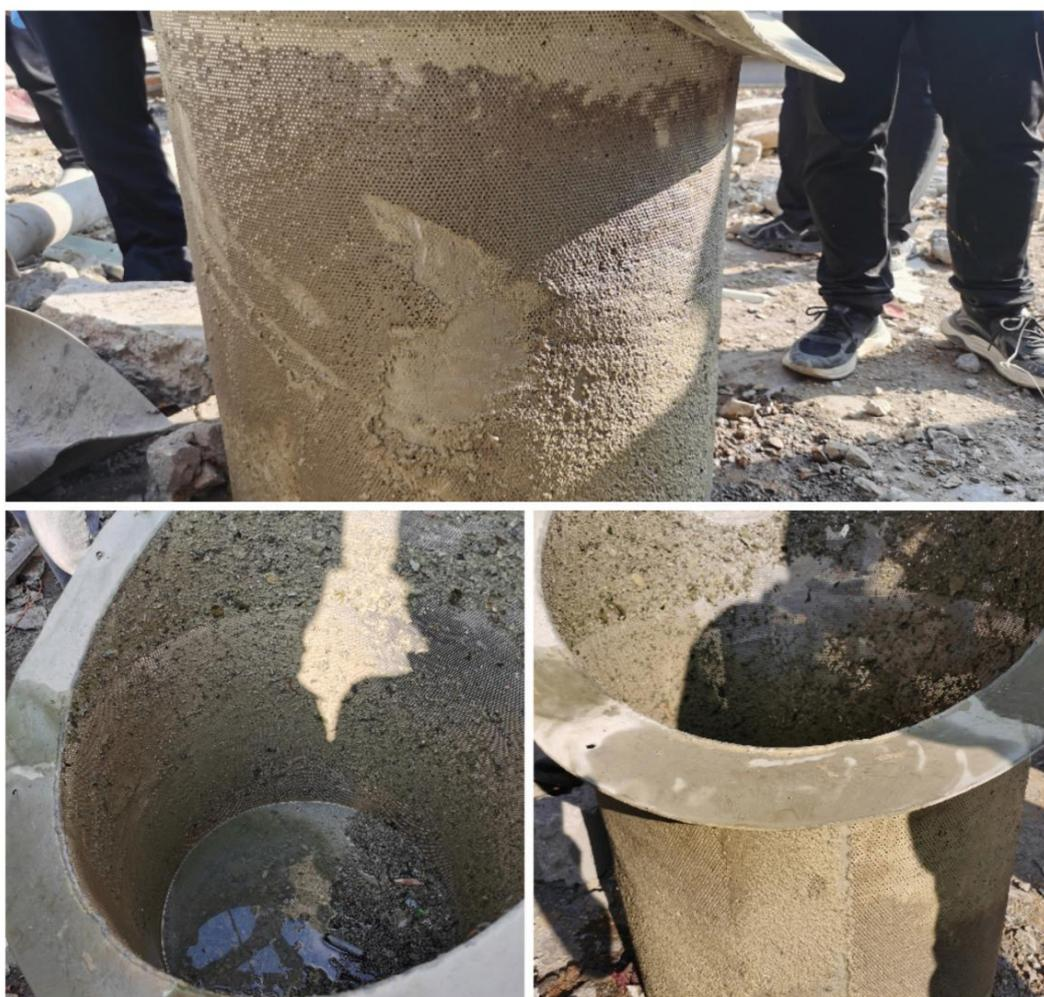
图 6 2#冷却水泵过滤器滤网
