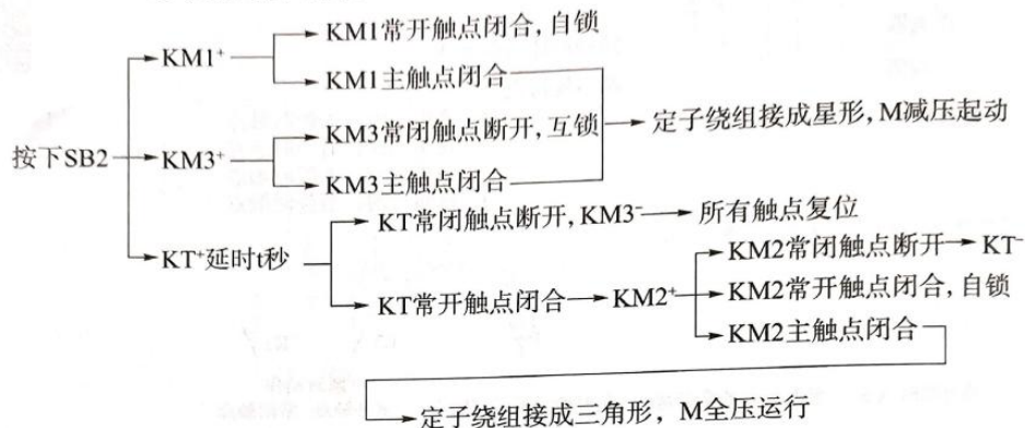
7-2 时间继电器控制的星-三角减压启动线路
