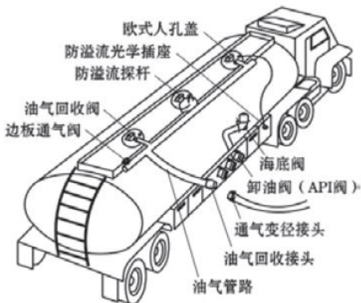
图 2.3-1 油罐车油气回收装置示意图
